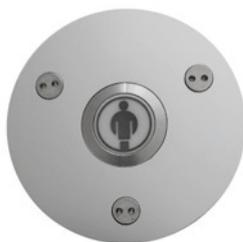
Vandalengeschützte Rufeinheit, als Ersatz für den Artikel 71185E2, zur Bereitstellung der benötigten Rufanlagenfunktionen im Patientenzimmer. Ausgeführt mit integriertem LED-Findlicht und Beruhigungsleuchte. Einsatz eines mechanischen Mikroschalters mit taktile Rückmeldung bei der Betätigung. Anbindung der Rufeinheit über den Rufeingang (I/O) an einen übergeordneten (IP)-Zimmerkontroller wie ein Systevo Zimmerterminal Protect oder ein Zimmer-Elektronikmodul.
