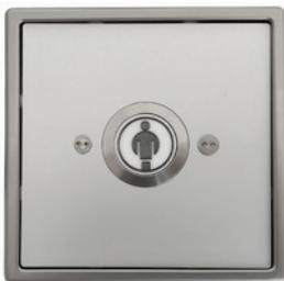
Vandalengeschützte Rufeinheit zur Bereitstellung der benötigten Rufanlagenfunktionen im Patientenzimmer. Ausgeführt mit integriertem LED-Findlicht und Beruhigungsleuchte. Einsatz eines mechanischen Mikroschalters mit taktile Rückmeldung bei der Betätigung. Anbindung der Rufeinheit über den Rufeingang (I/O) an einen übergeordneten (IP)-Zimmerkontroller wie ein Systevo Zimmerterminal Protect oder ein Zimmer-Elektronikmodul. Befestigung in uP-Dose.
