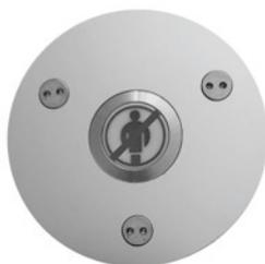
Vandalengeschützte Abstelleinheit, als Ersatz für den Artikel 71185D2, zur Bereitstellung der benötigten Abstellfunktion im Patientenzimmer. Ausgeführt mit integriertem LED-Licht. Einsatz eines mechanischen Mikroschalters mit taktile Rückmeldung bei der Betätigung. Anbindung der Rufeinheit über den Rufeingang (I/O) an einen übergeordneten (IP)-Zimmerkontroller wie ein Systevo Zimmerterminal Protect oder ein Zimmer-Elektronikmodul.
