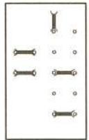
② An Elektronik-Modul muß diese Kodierung eingesteckt sein.
