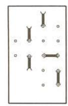
② An Elektronik-Modul muß diese Kodierung eingesetzt sein.
