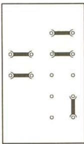
② Am Elektronik-Modul muß diese Kodierung eingestellt sein.
