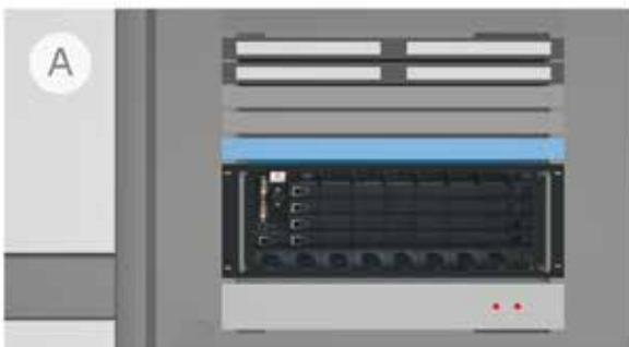
Die Systemerweiterung mit ITK-Mehrwertdiensten im 19" Verteilerschrank besteht aus Servern, System-Switch und USV.
