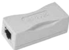
Netzwerkisolator für die galvanische Trennung der Rufanlage von externen Systemen gemäß der Norm IEC EN 60601-1. Einsatz als Bestandteil eines medizinisch-elektrischen Systems, um den Schutz des Patienten vor gefährlichen Ableitströmen zu gewährleisten.
