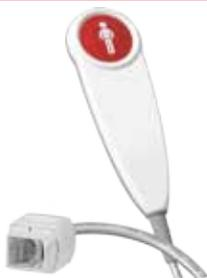
Birntaster in ergonomischer Gehäuseausführung (IP 67). Anschlussstecker selbstlösend A-kodiert mit einer Anschlussleitung von 2,5 m. Leicht bedienbare Ruftaste mit integriertem Findellicht. Ruftaste Ausführung in Ruhestrom.
