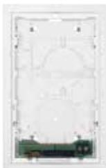
Hohlwand-Anschlussträger für Zimmerterminal als Zimmerverteiler mit Steckklemmen für den Anschluss der Spannungsversorgung, der Busleitungen sowie der passiven Ruf-Abstelleinheiten und der Zimmersignalleuchte. Der Anschlussträger beinhaltet die Überstromschutzelemente für die abgehende Zimmerverkabelung. Die Versorgungsklemmen sind steckbare Schraubklemmen, alle übrigen Anschlüsse sind als Steckklemmen ausgeführt.
